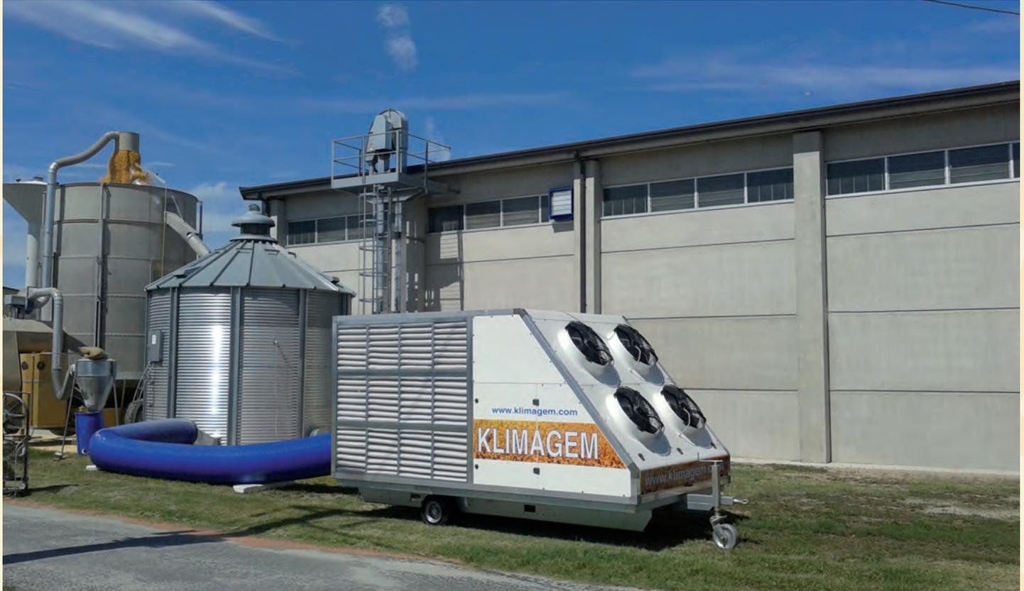
Application avec système de réfrigération KLIMAGRAIN mono-étagé - Application with KLIMAGRAIN single-stage cooling system
